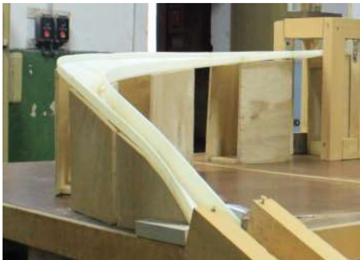
Рис. 4 – Вид собранной модели лотка, установленной на лабораторной установке
