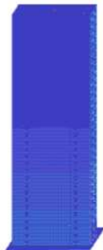
Рис. 4 – Изополя углов поворота U_x (2-е ветровое нагружение)
