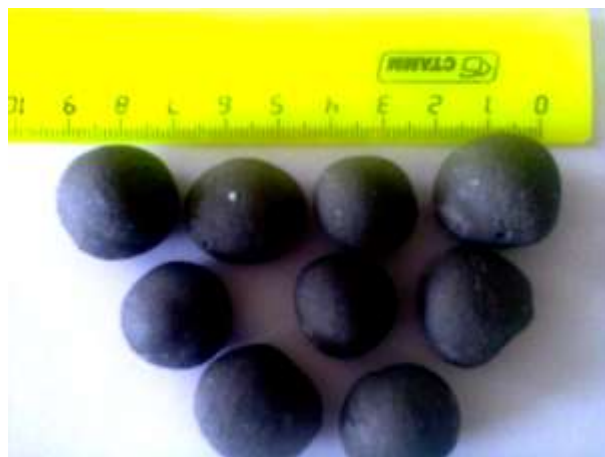
Рис. 2 – Фото гранулированного силикатнатриевого материала (состав: жидкое натриевое стекло; опока; кремнефтористый натрий (10 % по массе связующего))
