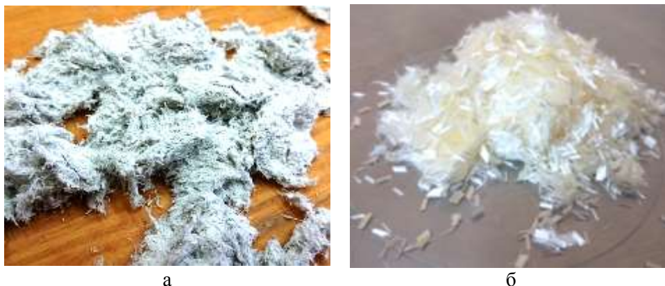
Рис. 1 – Внешний вид фибры: волокна хризотил-асбеста (а), полиакриловые волокна (б)
