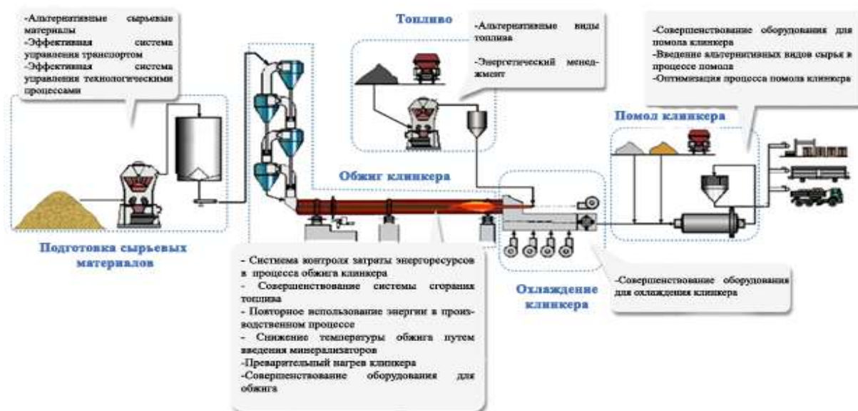
Рис. 3 – Возможные пути повышения энергоэффективности производства цемента
