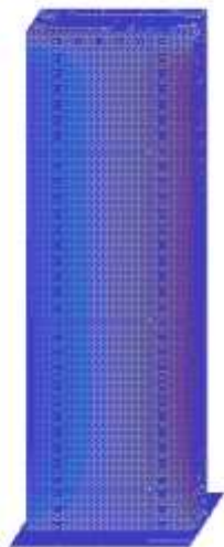
Рис. 3 – Изополя перемещений X (сочетание 1: 1*По+1*Дл+1*Кр)
