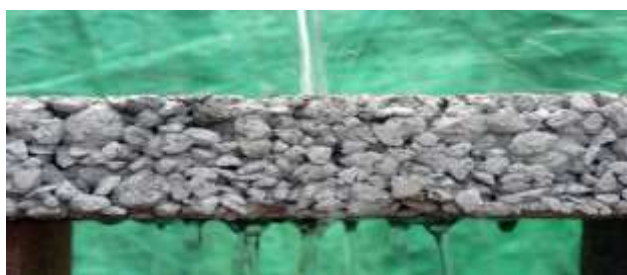
Рис. 1 – Испытания образца пористого бетона при проливе его струёй воды
