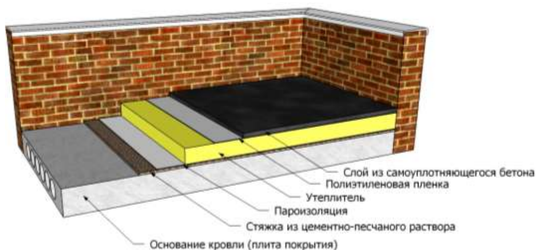
Рис. 1 – Конструкция безрулонной кровли из СУБ
