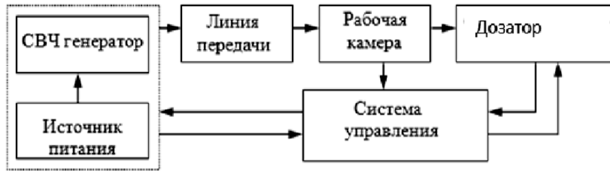
Рис. 1. Блок-схема установки по получению нано- и микро частиц оксида железа
