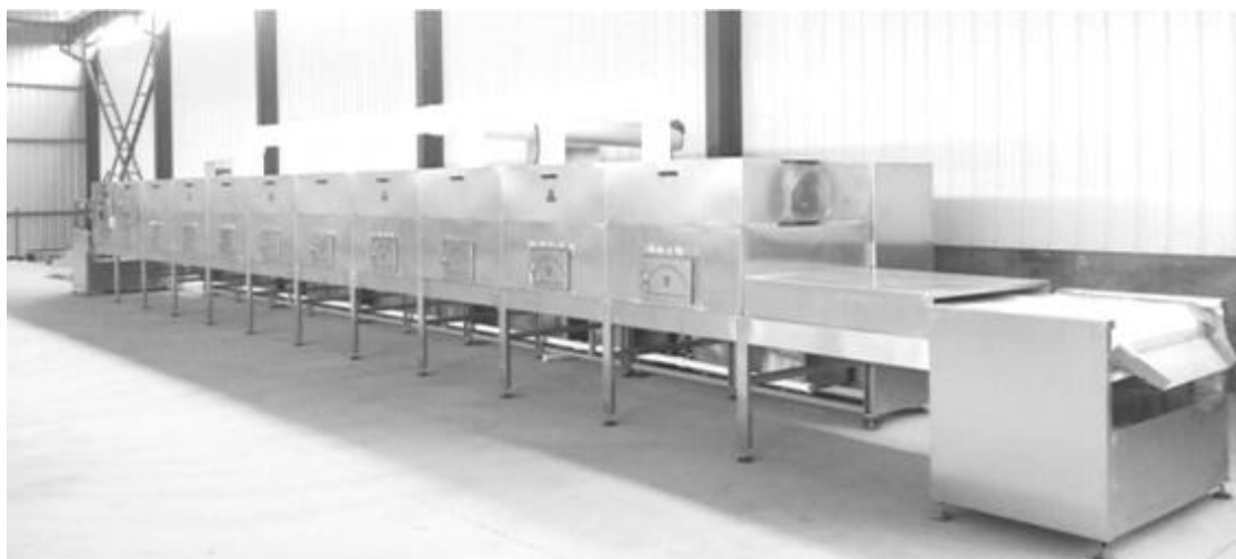
Рис. 1. СВЧ-установка конвейерного типа для сушки пищевых продуктов
