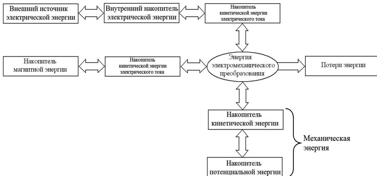
**Рис. 3.** Уточненная параллельная структурная схема процесса электромеханического преобразования энергии
