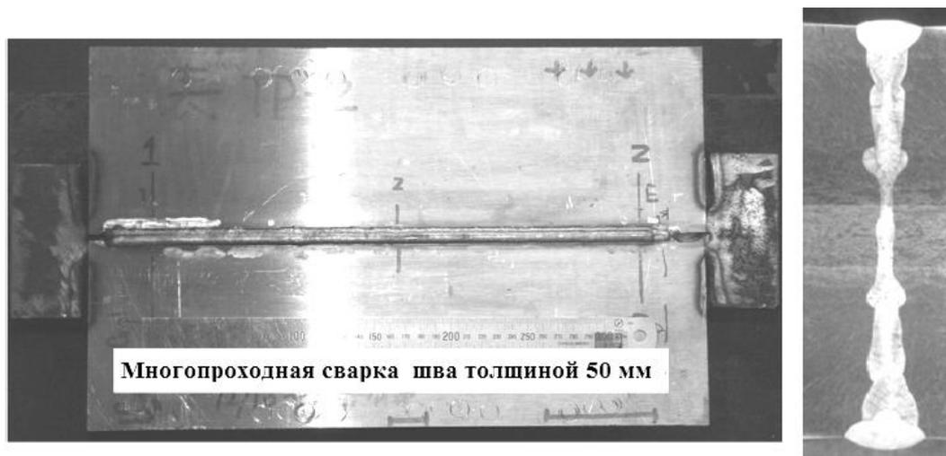
Рис. 10. Пример многопроходной лазерной сварки деталей толщиной 50 мм
