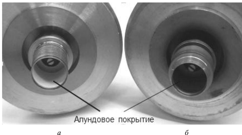
**Рис. 3.** Узел «Ножка катодная»: *а* – до операции обезгаживания и пайки; *б* – после операции обезгаживания
