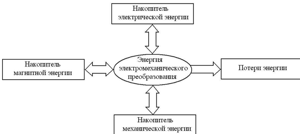
Рис. 2. Параллельная структурная схема процесса электромеханического преобразования энергии
