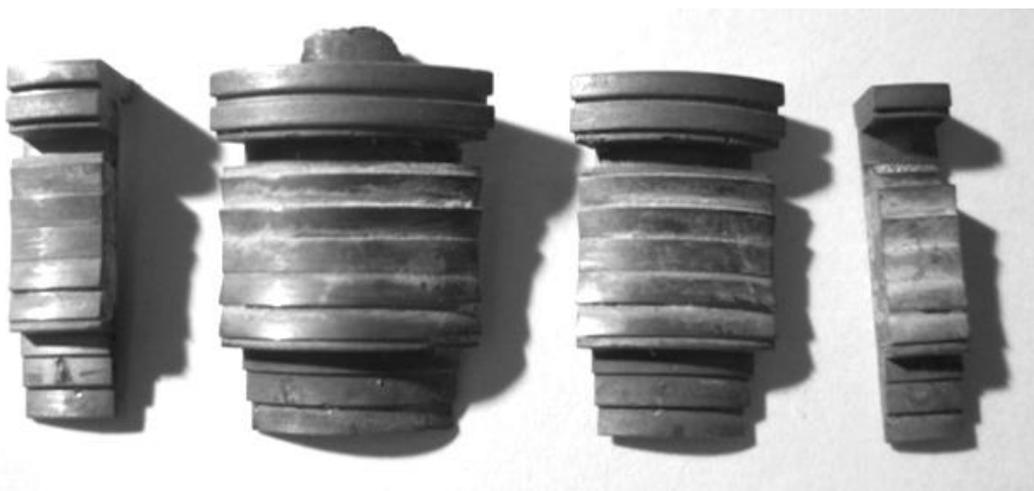
**Рис. 5.** Импрегнированные катоды, паянные методом индукционной пайки
