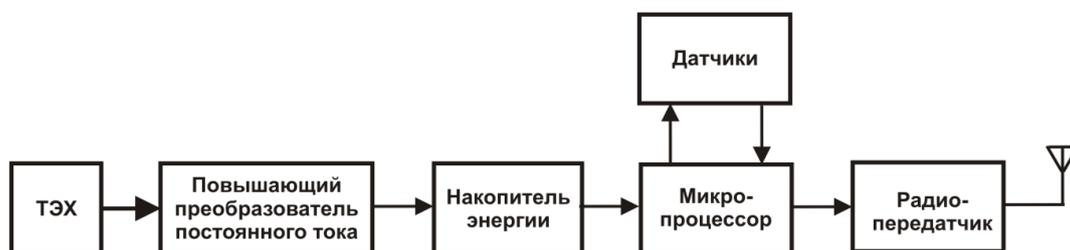
Рис. 4. Структурная схема системы электропитания беспроводных датчиков
