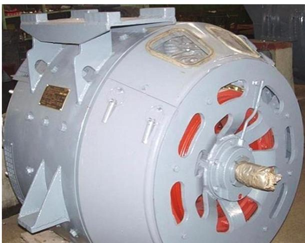
**Рис. 2.** Генератор синхронный тяговый ГСТ 2800-1000У2 тепловоза ТЭП-70
