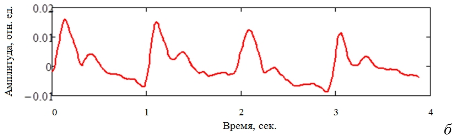
Рис.1. а – автодинный сигнал полупроводникового лазера, б – форма пульсовой волны, восстановленная из автодинного сигнала с использованием вейвлет-преобразований
