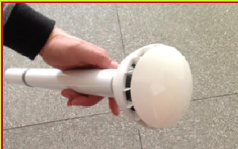
В настоящее время имеется три модификации Air Umbrella (А, В и С). Первая из них имеет длину 30 сантиметров при весе около 500 грамм, а время автономной работы составляет порядка 15 минут. Вторая модификация имеет длину 0,5 метра, вес 800 граммов и способна проработать около 30 минут. Последняя модификация весит 850 граммов и ее длина может быть увеличена до 80 сантиметров.
