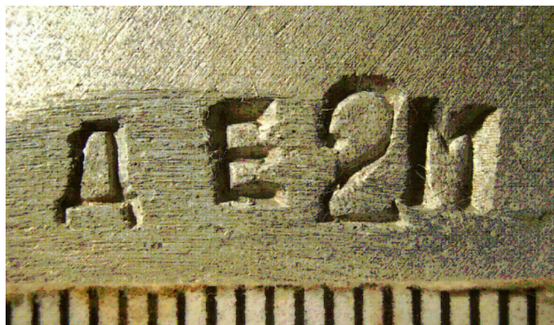
Рис. 4. Результат восстановления маркировочных обозначений на образце, выпиленном из блока двигателя ГАЗ-3102 (сплав АЛ-4), при использовании в качестве электролита 30 %-ного водного раствора соляной кислоты
