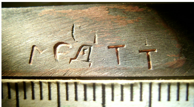
Рис. 3. Результат восстановления маркировочных обозначений на образце, выпиленном из блока двигателя ВАЗ-2106 (серый чугун) при использовании электролита на основе сернокислой меди, серной кислоты и желатина
