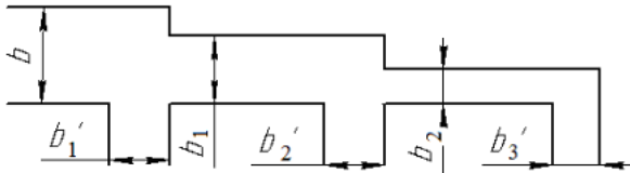
Рис.2. Схема участка опоясывающего волновода с переменным сечением узкой стенки с тремя последовательными отверстиями связи
