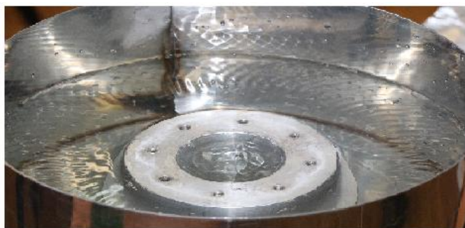
Рис. 5 Ультразвуковые волны на поверхности моющей жидкости при работающем излучателе
