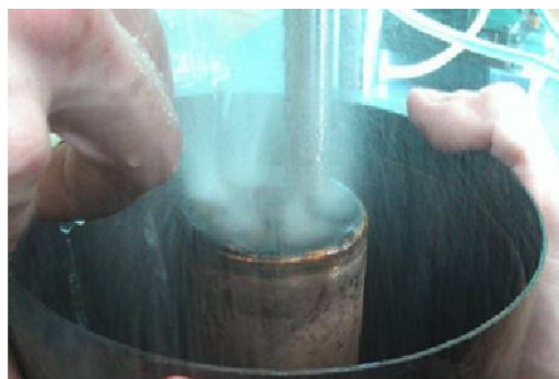
Рис. 4 Фонтаны на торцевой поверхности горелки при специальной схеме ультразвукового воздействия.
