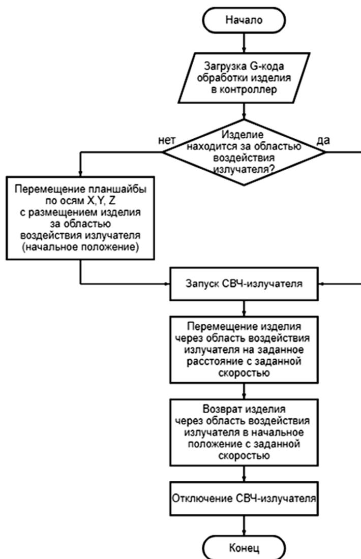
Рис. 8. Обобщенная блок-схема типовой программы динамической обработки резинового кольца диаметром 60-200 мм
