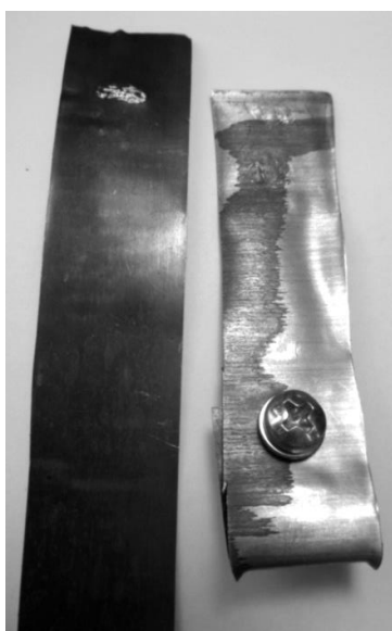
Рис. 3. Образец тонколистовой меди для проведения исследований и внешний вид сварного шва при растяжении сваренных листов друг относительно друга
