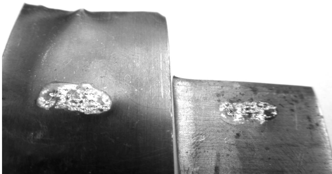
Рис. 4. Образец тонколистовой меди со сварным швом после проведения исследований прочности соединения
