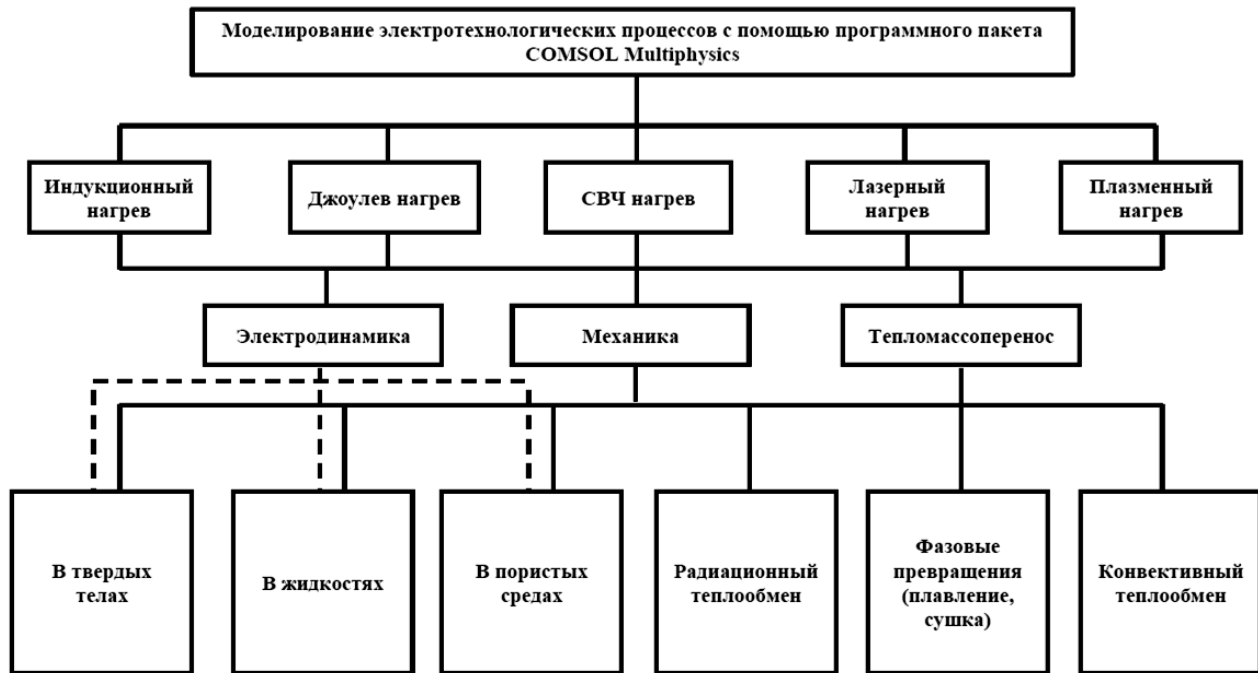
Рис. 1. Основные направления применения пакета COMSOL Multiphysics для моделирования электротехнологических процессов
