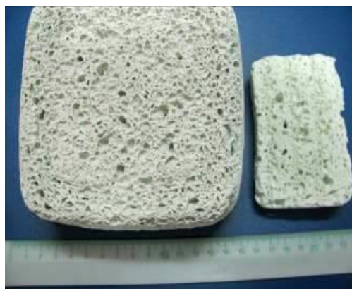
Рис. 3. Блоки пеностекла, полученного в СВЧ печи
