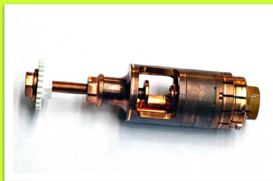
«Главным преимуществом разработанной ячейки является возможность проводить исследования деформации образца, вызванной магнитострикцией и пьезоэффектом, одновременно прикладывая магнитное и электрическое поля. Кроме этого, существует возможность проводить измерения в условиях вакуума при гелиевых (сверхнизких) температурах, что приближенно к космическим
