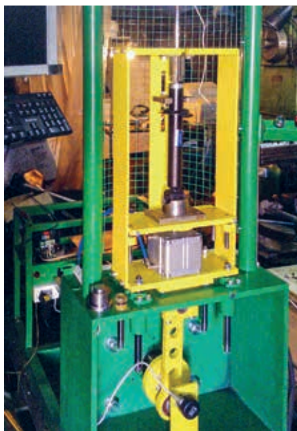
Установка для испытания амортизатора ЭНГА
