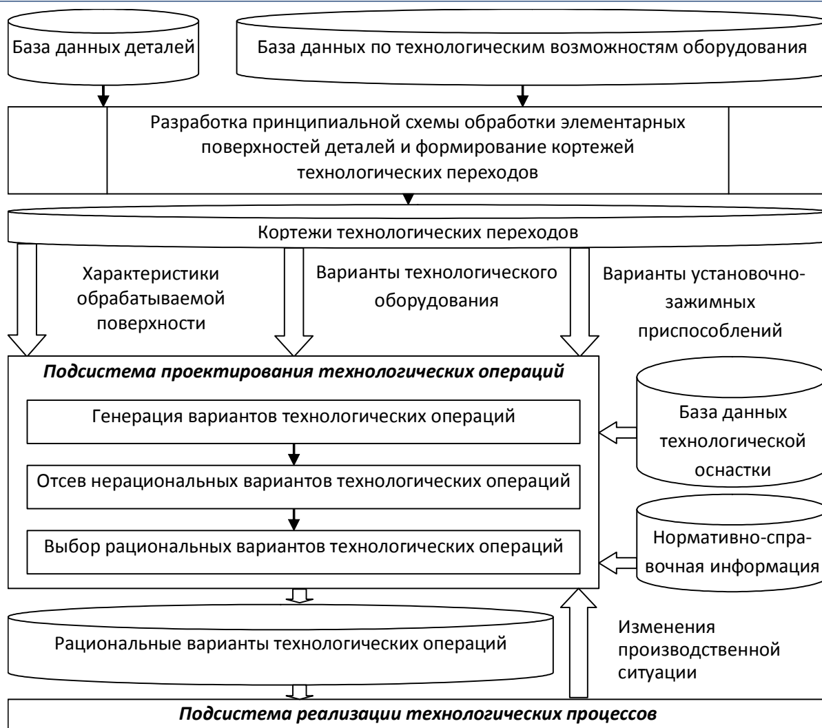
Рис. 2. Структурная модель подсистемы проектирования операций механической обработки
