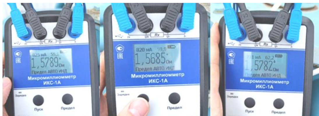
Рис. 2. ИКС-1А с результатами измерений сторона ВН
