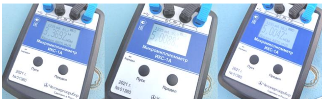
Рис. 3. ИКС-1А с результатами измерений сторона НН
