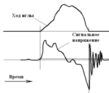
Рис. 1. Реальное перемещение иглы и сигнал встроенного индуктивного датчика перемещения иглы
