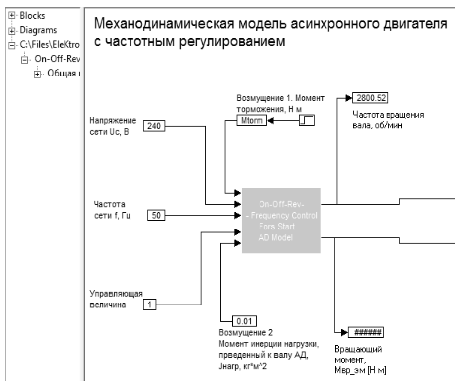
Рис. 2. Модель асинхронного двигателя с частотным регулированием
