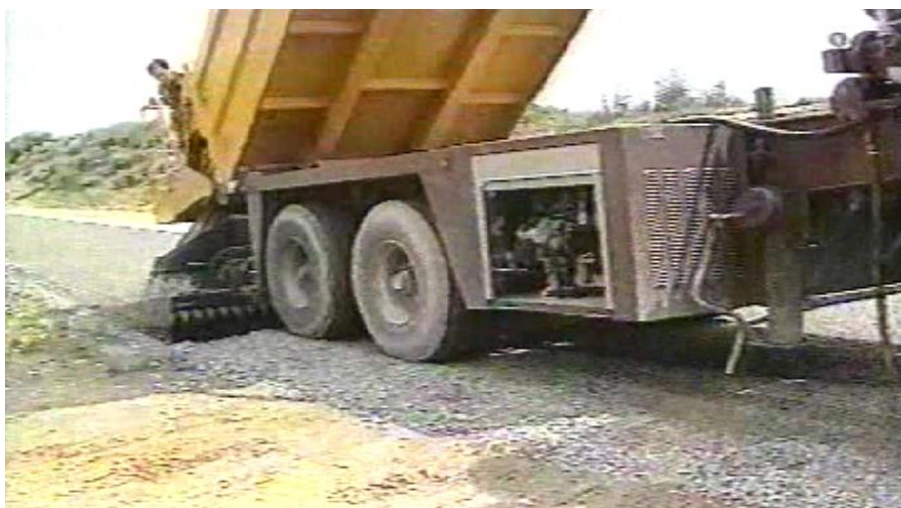
Рис. 3. Значительное изменение взаимного положения шасси и осей колес битумощебнераспределителя при подъеме загруженного кузова
