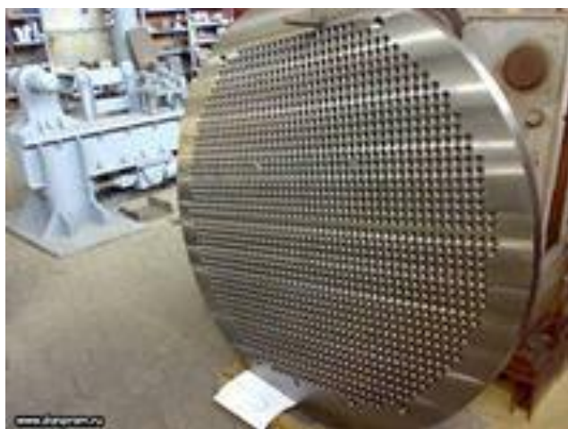
Рис. 8. Трубная доска теплообменника с массовым количеством отверстий
