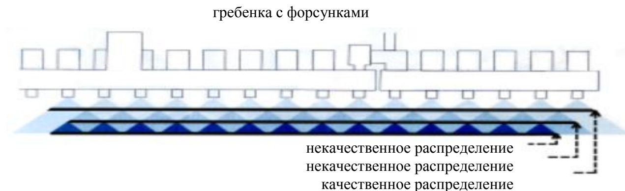
Рис. 6. Синхронное распределение вяжущего и щебня
