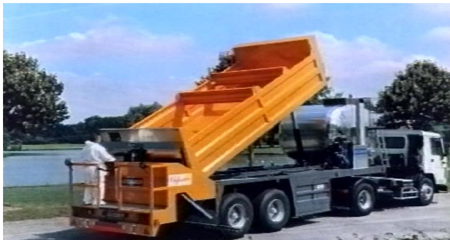
Рис. 2. Изменение взаимного положения шасси и осей колес при подъеме кузова битумощебнераспределителя без щебня
