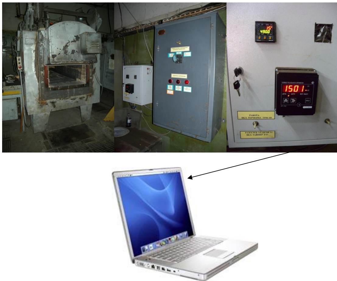
Рис. 4. Установка термообработки с системой управления
