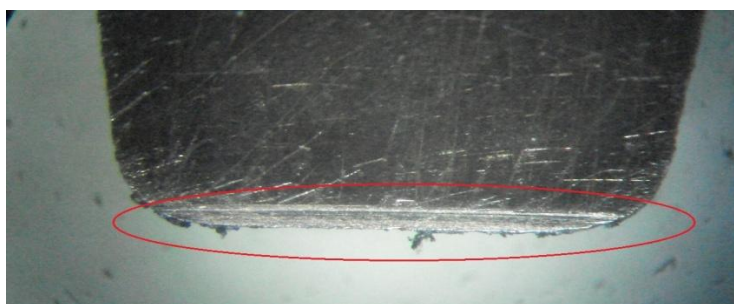
Рис. 3. Контактная поверхность щётки БрБ-2 при окислительном износе
