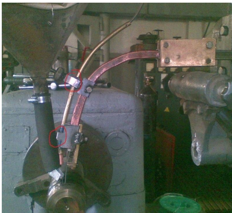
Рис. 1. Наплавочная головка с дополнительным подающим механизмом
