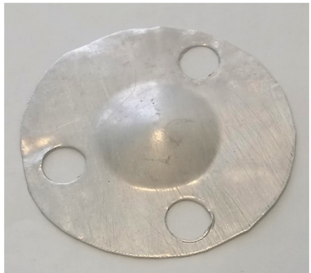
Рис. 2. Образец пластически деформированного крешера из алюминия марки АК12, выполненного в виде пластины с заземленными краями
