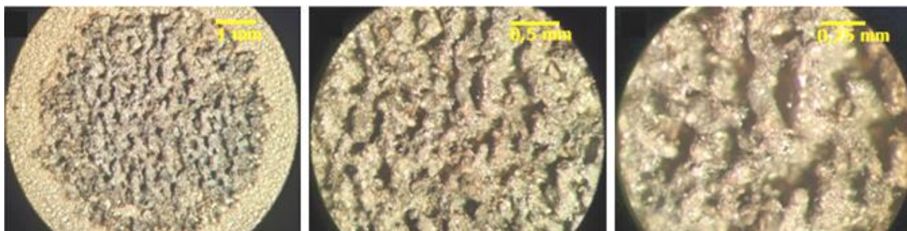
Рис. 2. Лабиринтная структура Al_2O_3 спеченного порошка при мощности излучения 620 Вт, энергии импульсов 0,31 Дж, частоте 20 Гц и шаге сканирования 0,3 мм, полученная при 4-х проходах (диаметр пятна спекания 8 мм)
