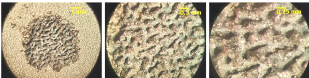
Рис. 3. Лабиринтная структура Al_2O_3 спеченного порошка при мощности излучения 840 Вт, энергии импульсов 0,42 Дж, частоте 20 Гц и шаге сканирования 0,1 мм, полученная при 5-ти проходах (диаметр пятна спекания 5 мм)
