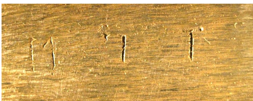
Рис. 3. Результат электролитического травления на стали марки 20Х13 при использовании в качестве электролита раствора следующего состава: концентрированная соляная кислота – 38 мл, концентрированная серная кислота – 12 мл, вода дистиллированная – 15 мл с последующей обработкой поверхности ватным тампоном, смоченным этиловым спиртом
