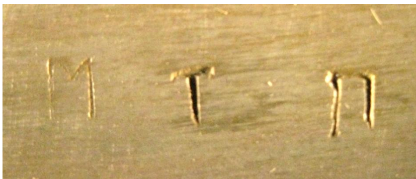
Рис. 5. Результат электролитического травления на стали марки 70C2XA при использовании в качестве электролита 15%-го водного раствора двуххромовокислого калия
