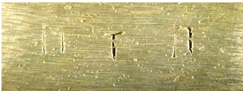
Рис. 7. Результат электролитического травления на стали марки 09Г2С при использовании в качестве электролита 1%-го водного раствора азотной кислоты
