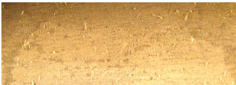
Рис. 1. Иллюстрация отсутствия электролитического травления на стали марки 12Х18Н10Т при использовании в качестве электролита 30%-го водного раствора молибденовокислого аммония
