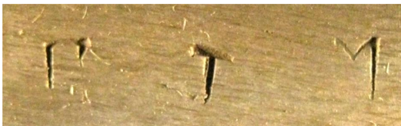
Рис. 2. Результат электролитического травления на стали марки 60С2А с использованием в качестве электролита 1%-го водного раствора серной кислоты с последующей обработкой поверхности ватным тампоном, смоченным дистиллированной водой
