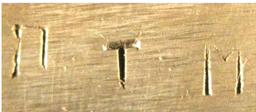
Рис. 6. Результат электролитического травления на стали марки 20X13 при использовании в качестве электролита раствора следующего состава: сернокислая медь – 1 г, желатин – 1 г, концентрированная серная кислота – 10 мл, вода дистиллированная – 500 мл
