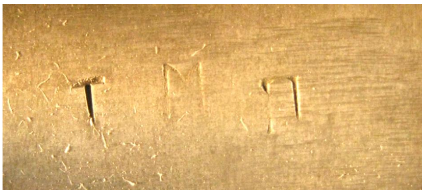
Рис. 8. Результат электролитического травления на стали марки Ст10 при использовании в качестве электролита 1%-го водного раствора серной кислоты
