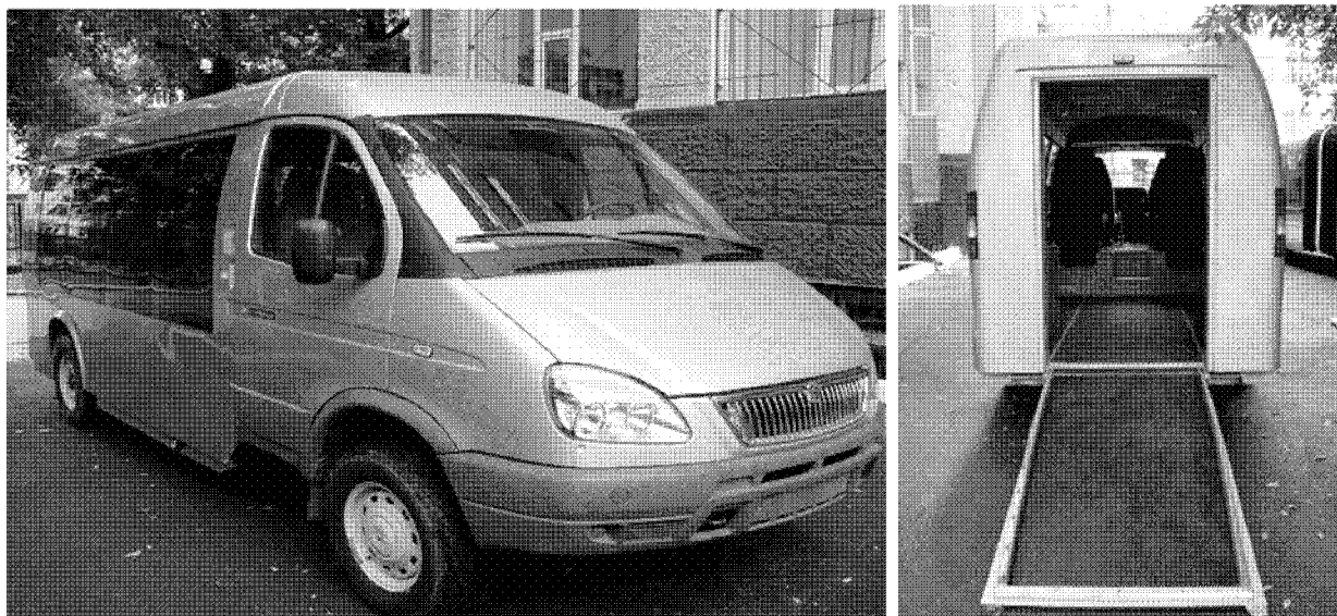
Рис. 4. Опытный образец специального автомобиля для перевозки инвалидов в креслах-колясках
