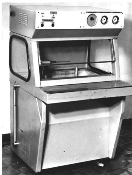
**Рис. 4.** Установка ультразвуковой промывки отверстий УУПО-901
