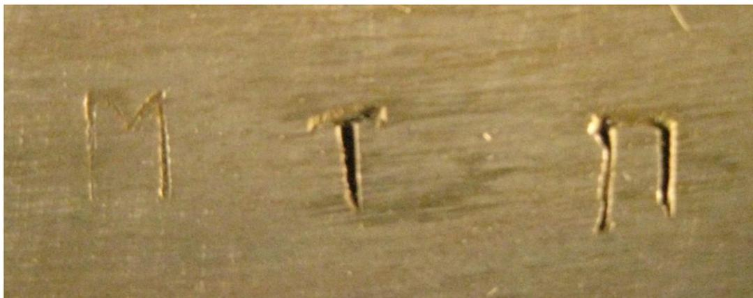
**Рис. 3.** Результат восстановления маркировочных обозначений с использованием электролита на основе 15 %-ого водного раствора бихромата калия
