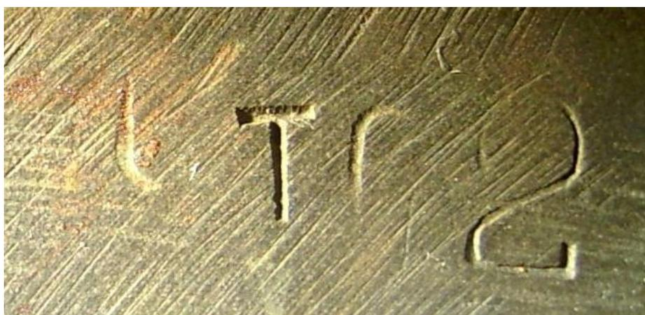
**Рис. 2.** Результат восстановления маркировочных обозначений с использованием электролита на основе 10 %-ого водного раствора персульфата аммония
