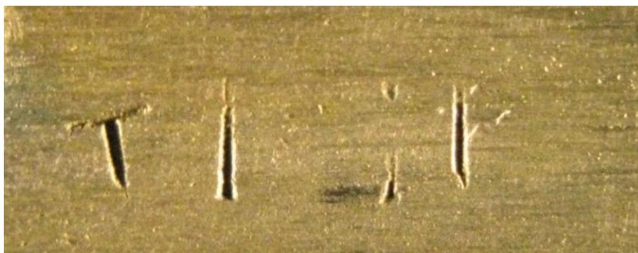
**Рис. 1.** Результат восстановления маркировочных обозначений с использованием электролита следующего состава: сернокислая медь – 1г., желатин – 1г., концентрированная серная кислота – 10мл., вода дистиллированная – 500мл
