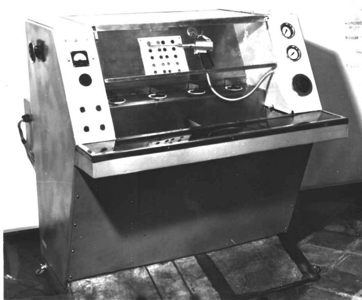
**Рис. 5.** Стенд ультразвуковой очистки деталей
