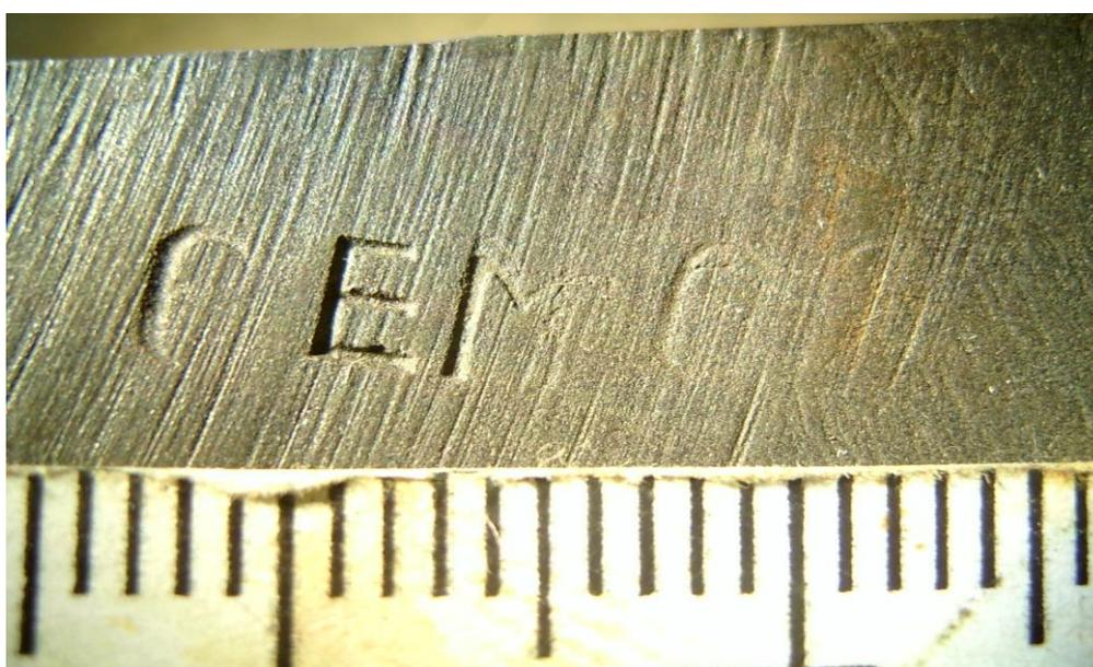
**Рис. 4.** Результат восстановления маркировочных обозначений с использованием электролита на основе 1 %-ого раствора серной кислоты
