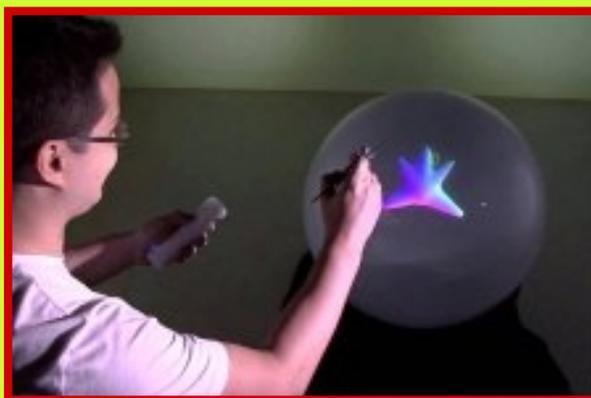
Устройство имеет форму полупрозрачной сферы, внутри которой зритель может видеть анимацию и изображения. Эта технология основана на оптической иллюзии. Внутри у основания шара Spheree размещено 8 мини-проекторов, которые подсвечивают изображения на внутреннюю поверхность сферы, а специальное программное обеспечение, разработанное командой, склеивает отдельные изображения проектора вместе, создавая одно целое изображение.
