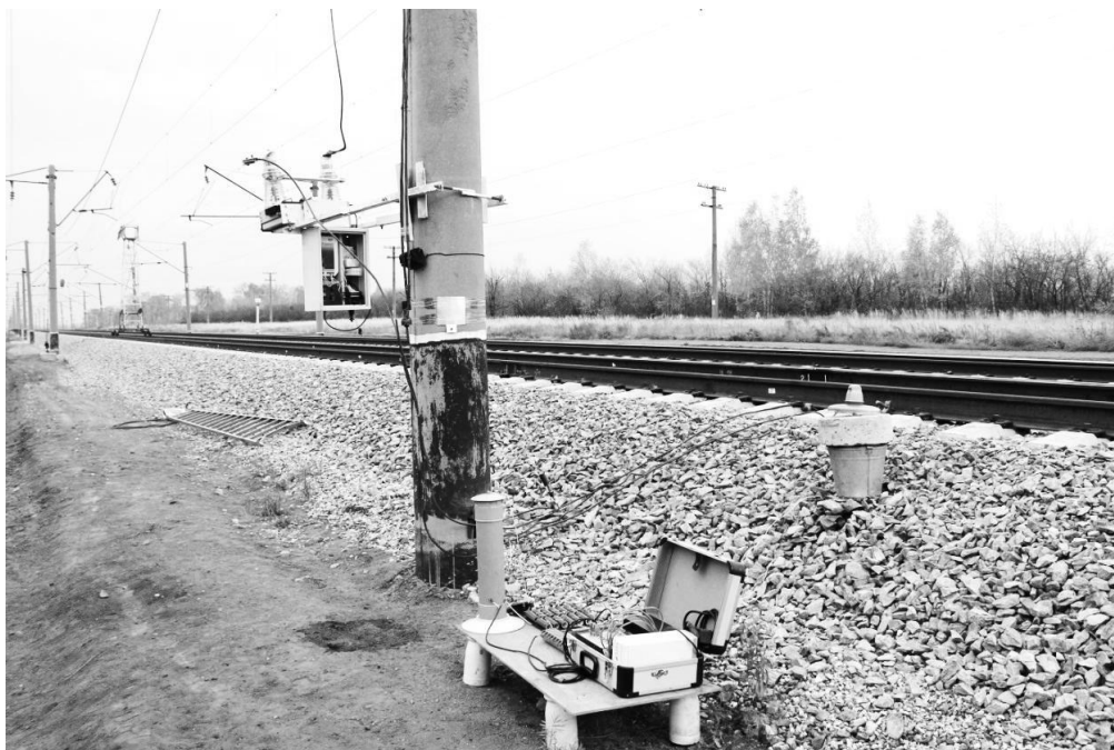
Рис. 2. Проведение экспериментальных исследований условий электробезопасности и электромагнитного влияния
