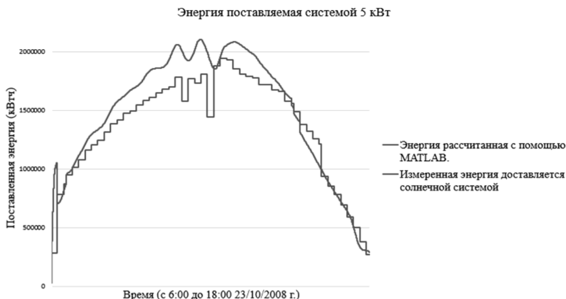
Рис. 12. Валидация данных, рассчитанных по математической модели СЭС мощностью 5 кВт в MATLAB / SIMULINK
