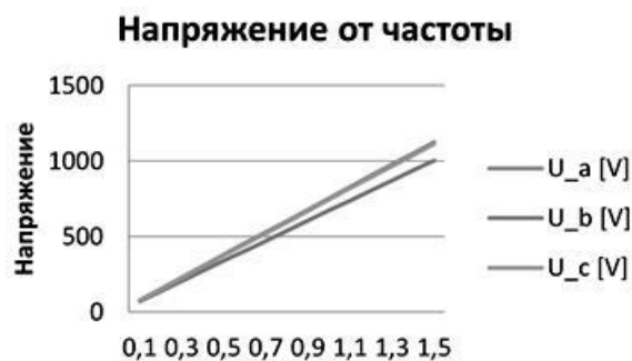
Рис. 7. Зависимость напряжения от частоты (при уровне расплава 0,8 м)
