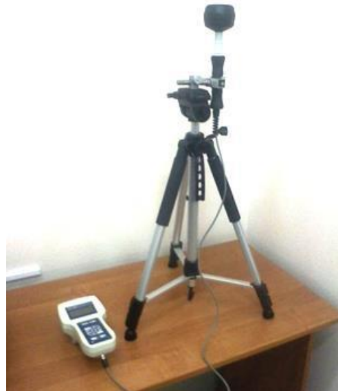
Рис. 2. Электронный измеритель плотности потока энергии ПЗ-33М с антенной, закрепленной на штативе
