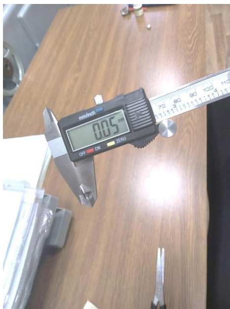
Рис. 2. Замер толщины фольги, закладываемой в подшипниковые узлы исследуемого генератора
