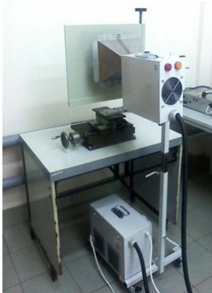
Рис. 1. Экспериментальная СВЧ установка на базе излучателя «Жук-2-02»
