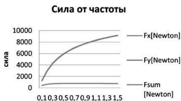
Рис. 8. Зависимость силы от частоты (при уровне расплава 0,8 м)
