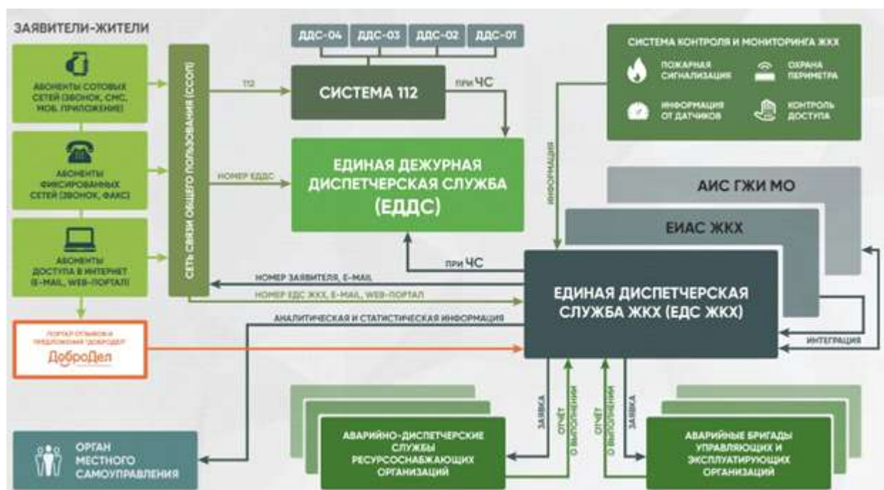
Рис. 1. Общая схема работы система автоматизации и учёта заявок и обращений
