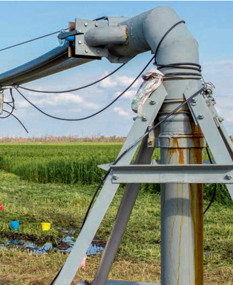
Многофункциональная дождевальная машина «Волга-СМ» с полиэтиленовым трубопроводом в работе
