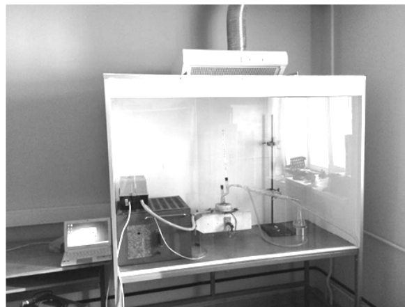
Рис. 2. Структурная схема и внешний вид установки для деполимеризации полистирола: 1 – СВЧ генератор; 2 – соединительный волновод; 3 – СВЧ резонаторная камера; 4 – круглодонная колба; 5 – насадка Вюрца; 6 – холодильник; 7 – ИК датчик температуры; 8 – контактный датчик температуры; 9 – алонж; 10 – приемник; 11 – компьютер; 12 – охлаждающий поток воды; 13 – индикатор измеряемого параметра
