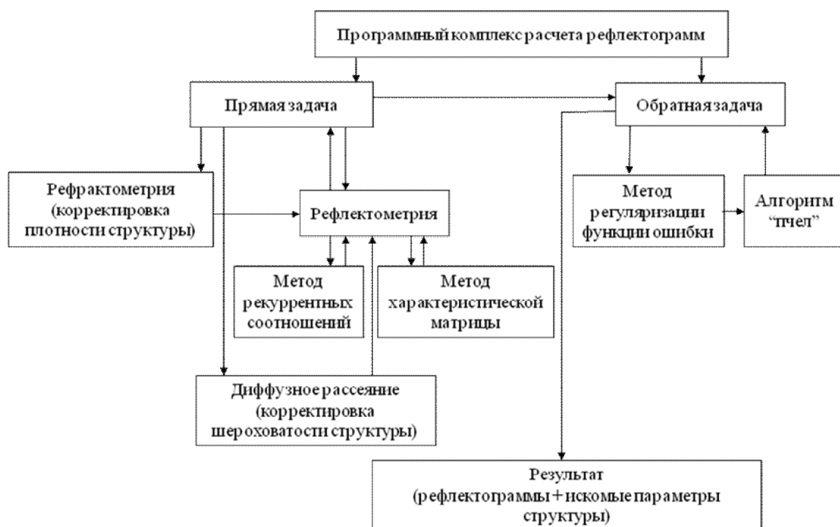
Рис.1. Блок-схема работы программного комплекса, реализующего совместное решение прямых и обратных задач для методов рентгеновской рефлектометрии, рефрактометрии и диффузного рассеяния рентгеновского излучения
