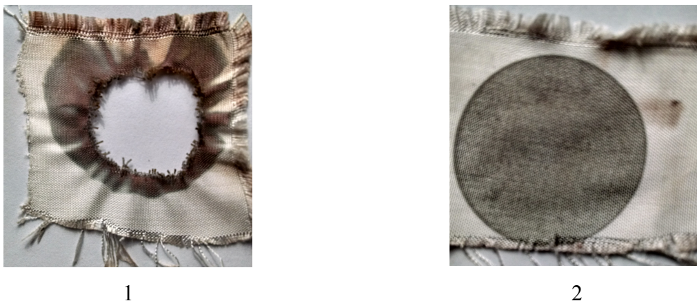
Рис.3. Поверхность материала основы после термического нанесения
