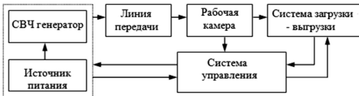
Рис. 1. Структурная схема СВЧ установки
