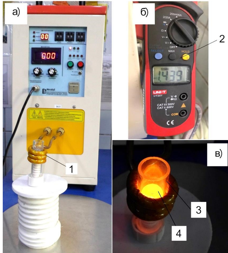
Рис. 1. Общий вид установки ВЧ15-А (а), контроль потребляемого тока от электрической сети при ИТО (б) и компоновка системы «индуктор-изделие» (в): 1 – водоохлаждаемый трехвитковый индуктор; 2 – токовые клещи; 3 – кварцевая трубчатая камера для ИТО (вертикальное открытое исполнение); 4 – обрабатываемый образец при высокотемпературной ИТО (яркое свечение)
