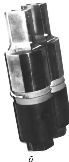
Рис. 5. Ультразвуковые пьезокерамические преобразователи: а – стержневой, б – двухпакетный с одним волноводом для работы с 4-мя инструментами
