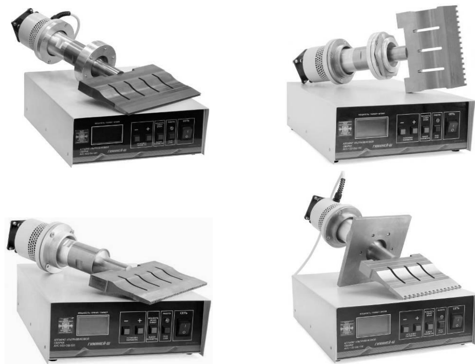
Рис. 8. Ультразвуковые аппараты с различными сварочными инструментами для производства георешёток
