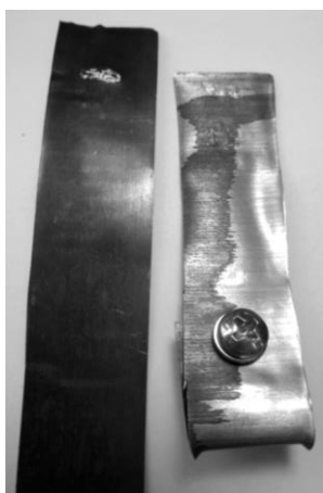
Рис. 3. Образец тонколистовой меди для проведения исследований и внешний вид сварного шва при растяжении сваренных листов друг относительно друга
