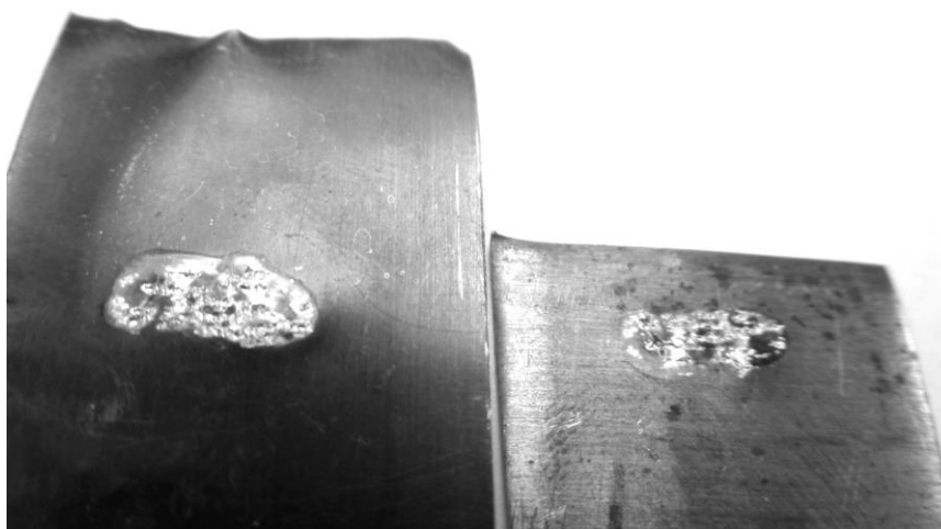
Рис. 4. Образец тонколистовой меди со сварным швом после проведения исследований прочности соединения
