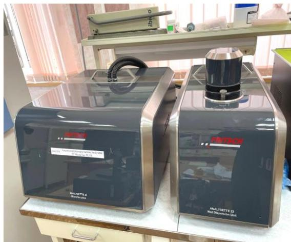
**Рис. 1.** Анализатор частиц Analysette 22 Micro Tec PLUS
