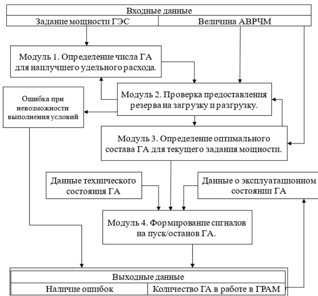
Рис. 3. Структурно-алгоритмическая схема работы РУСА с участием ГЭС в АВРЧМ
