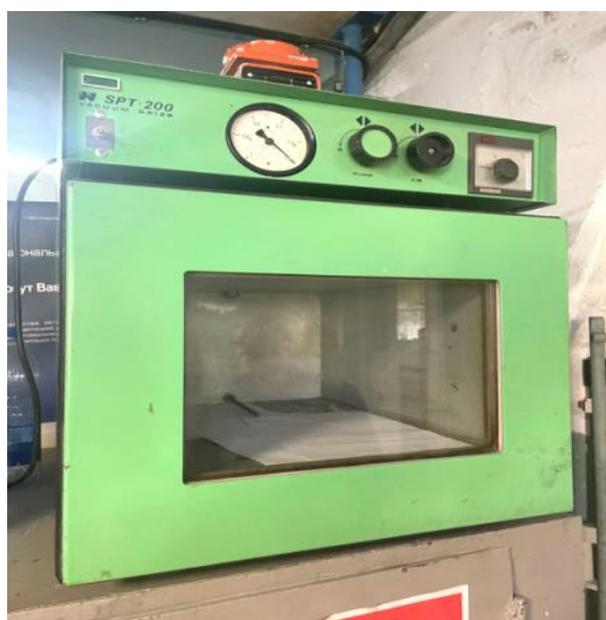
**Рис. 3.** Вакуумный шкаф
