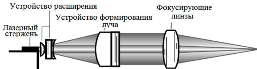
Рис. 12. Диодный лазер с устройствами для формирования излучения [6]
