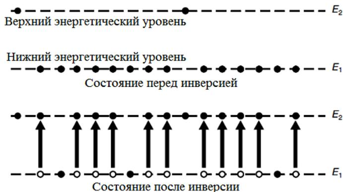
Рис. 2. Механизм создания инверсии
