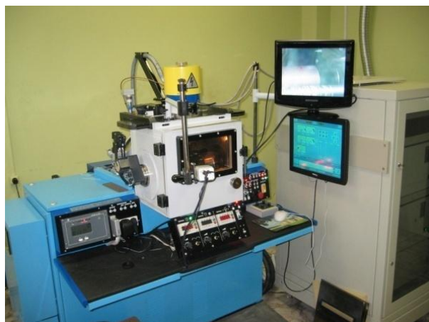
Рис. 5. Установка УЭЛС-905 (а) и ее вакуумная камера (б)
