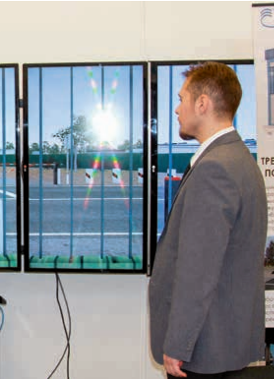
Тренажерный комплекс дежурного по железнодорожному переезду АО «ИНИУС» – визуализация всего, что происходит. На таком обучающийся учится «действовать», в том числе, в случае нештатной ситуации, может «выйти» из помещения на пути и даже «установить» сигнал или петарду
