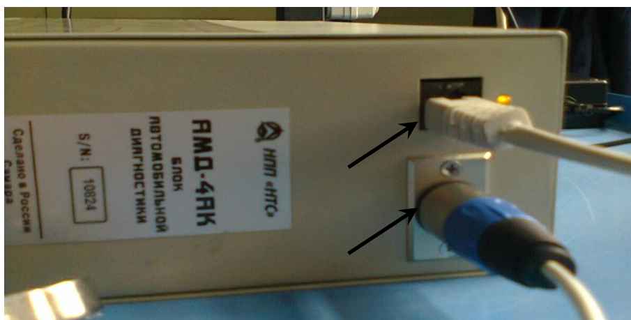
Рисунок 2 – Разъемы для подключения питания (снизу) и сетевого кабеля (сверху)
