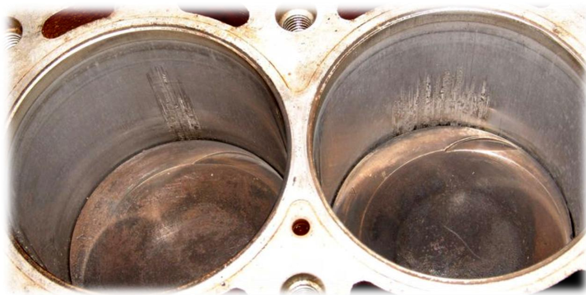
Рисунок 1 – Задиры в цилиндрах двигателя
