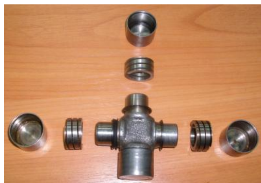
Рисунок 8 – Модернизированные крестовины автомобиля ВАЗ «Нива»
