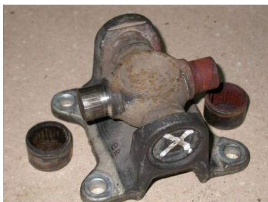
Рисунок 7 – Внешний вид изношенных деталей («ложное бринелирование») подшипникового узла крестовины
