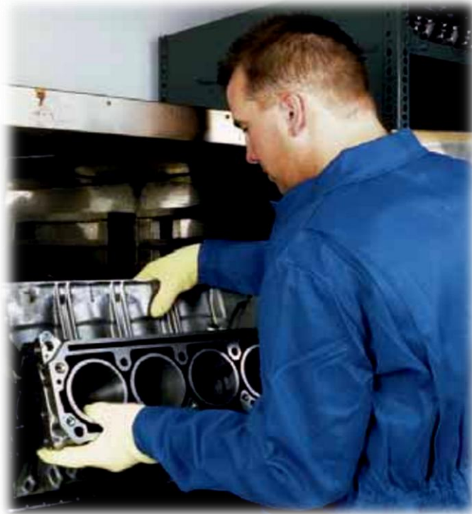
Рисунок 3 – Подогрев блока цилиндров в печи
