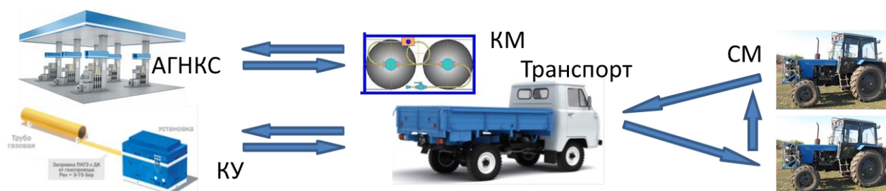
Рисунок 6 – Заправка с использованием кассетных модулей (КМ)
