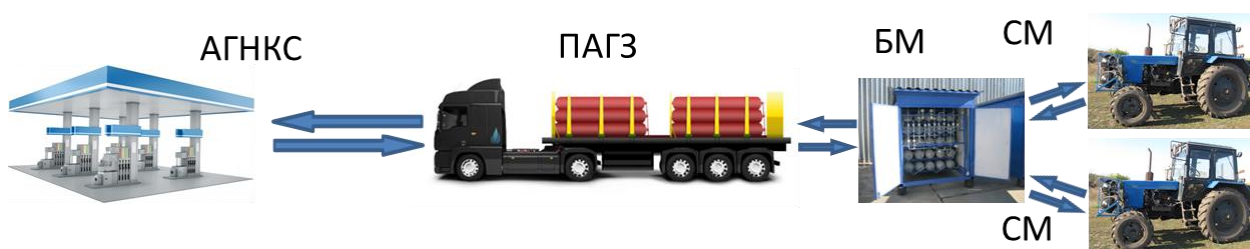
Рисунок 3 – Заправка с использованием ПАГЗ и узла промежуточного хранения природного газа в виде баллонных модулей
