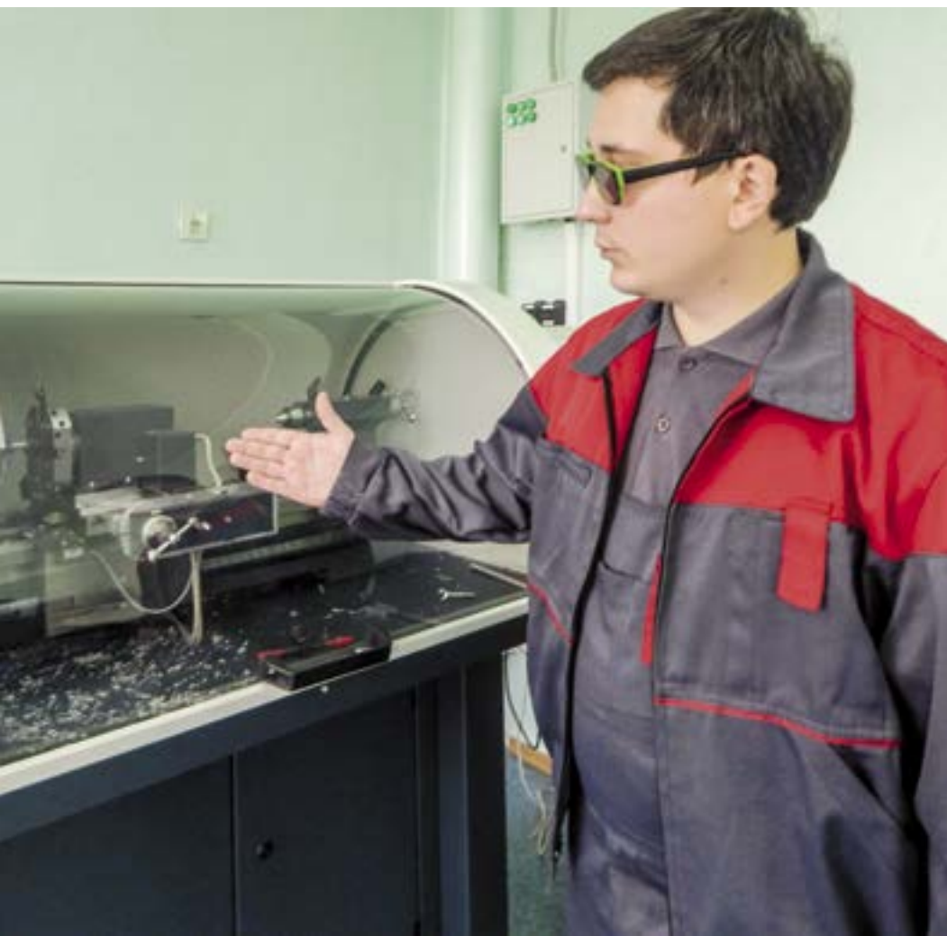
Учебный станок с ЧПУ обрабатывает детали по программам, разработанным студентами
