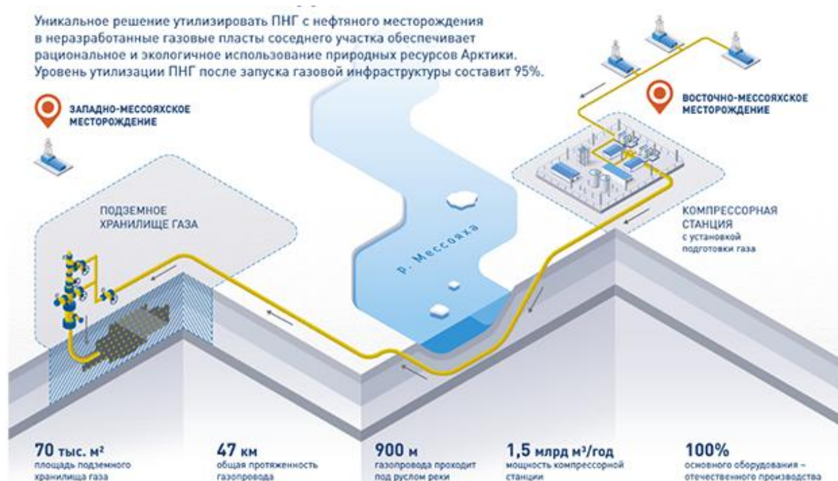
Рисунок 3. Проект реализации временного хранения попутного нефтяного газа
