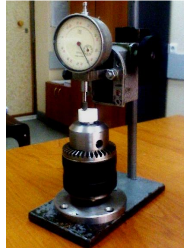
Рис. 2. Устройство измерения глубины канавки в образце
