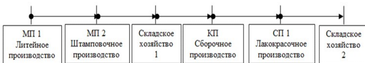
Рис. 1. Законченный производственный цикл промышленного производства при последовательном производстве
