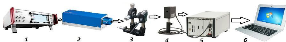
Рис. 1. Схема экспериментальной установки: 1 – ТОРТИКА DL 100: DL 100 лазерная диодная головка, \lambda = 830 нм; 2 – ТОРТИКА DL 100: модуль контроля лазерного излучения; 3 – объект; 4 – поляризационная головка PAN5710IR1 (700-1000 нм); 5 – автоматизированный поляриметр Thorlabs TXP 5004; 6 – ПК
