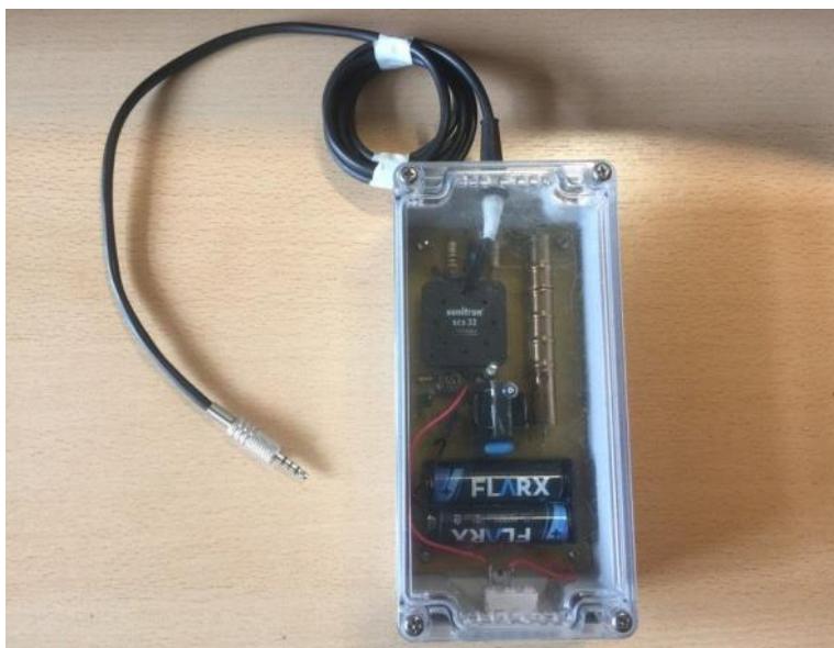
Рис. 1. Передняя панель портативного дозиметра с выходным кабелем
