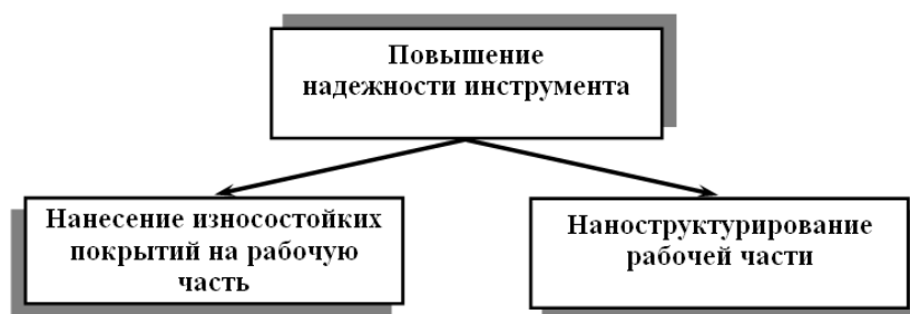
Рис. 1. Основные направления повышения надежности режущего инструмента
