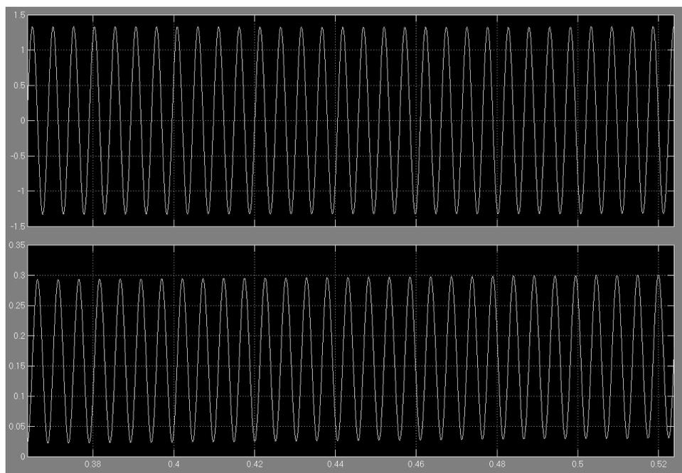
**Рис. 5.** Переходные процессы при неработоспособном состоянии двигателя ДК-211БМ
