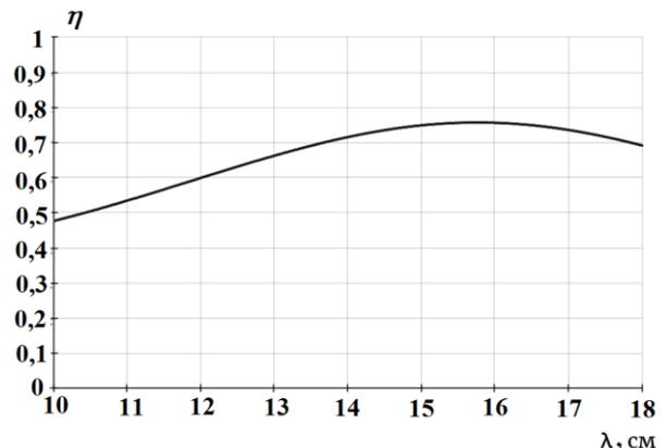
**Рис. 5.** Зависимость КПД рабочей камеры от длины волны при нагреве говядины
