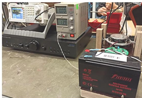
Рис. 2. Экспериментальная установка для исследования работы информационно-управляющей системы демпфирования колебаний электромагнитной подвески: 1 – функциональный генератор сигналов; 2 – усилитель; 3, 4 – вибромодули; 5 – информационно-управляющая система; 6 – блок питания; 7 – аккумуляторная батарея
