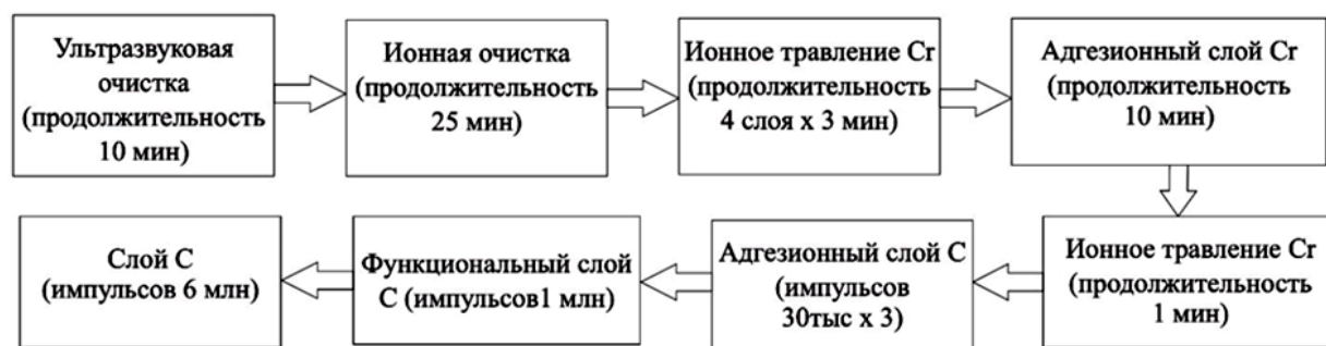
Рис. 2. Маршрутная карта PVD-нанесения покрытия на высоковакуумной установке DREVA 600
