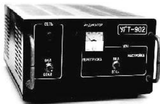
Рис. 3. Ультразвуковые тиристорные генераторы с системой автоподстройки частоты выходного сигнала
