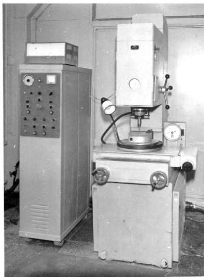
Рис. 4. Прошивочный станок для фрезерования поверхностей и сверления отверстий алмазным вращающимся инструментом
