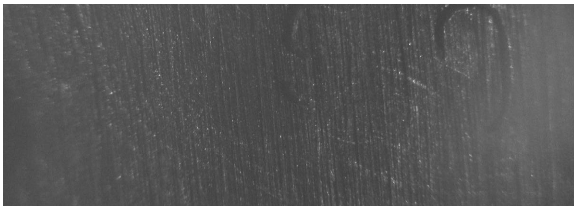
Рис. 2. Потемнение площадки в результате электролитического травления сплава Д1 при использовании в качестве электролита пятнадцатипроцентного раствора едкого натрия
