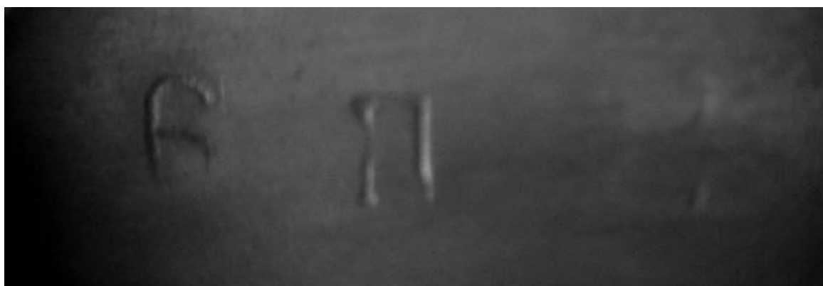
Рис. 3. Потемнение площадки в результате электролитического травления сплава Д1 при использовании в качестве электролита смеси следующего состава: хлорное железо - 40 г; хлорная медь - 13 г; вода дистил. - 100 мл
