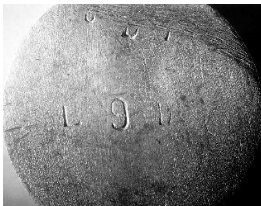
Рис. 1. Отсутствие электролитического травления сплава АД0 при использовании в качестве электролита однопроцентного водного раствора серной кислоты. Аналогичный результат наблюдали при использовании пятипроцентного водного раствора хлористого натрия, тридцатипроцентного водного раствора азотной кислоты. Подобный результат наблюдали также для сплава Д1
