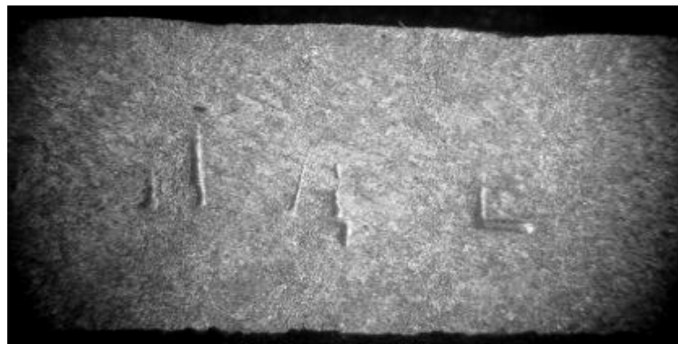
Рис. 4. Положительный результат электролитического травления сплава Д1 при использовании в качестве электролита двадцатипроцентного водного раствора соляной кислоты
