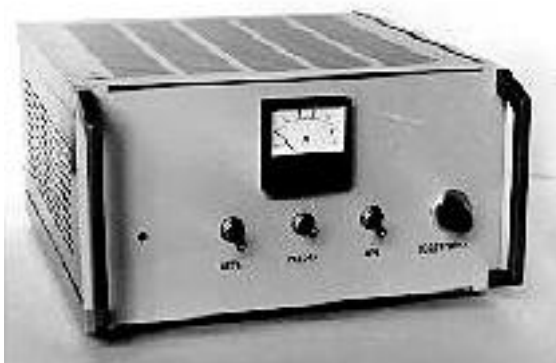
Рис. 3. Ультразвуковые тиристорные генераторы с системой автоподстройки частоты выходного сигнала
