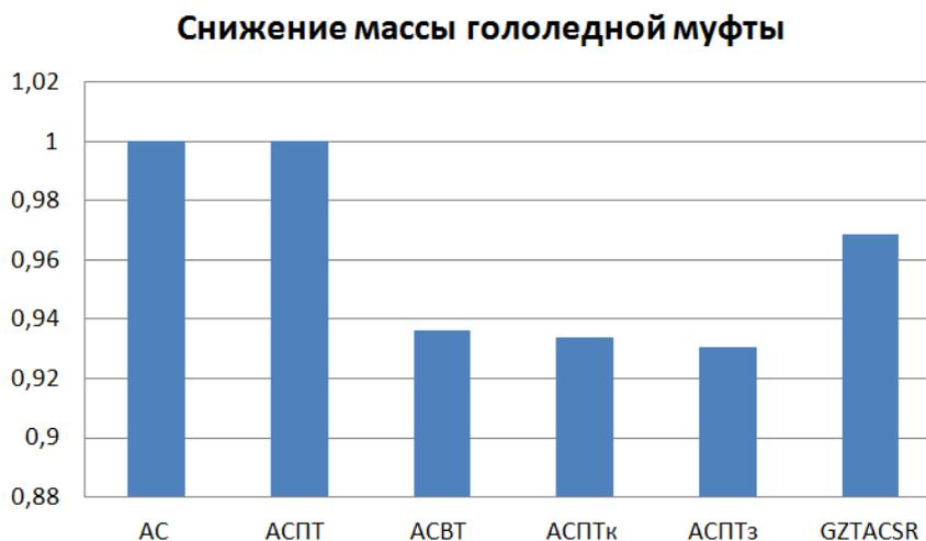
Рис. 7. Снижение массы гололедной муфты
