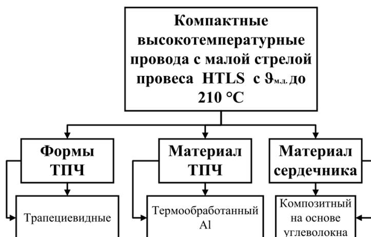
Рис. 8. Классификация компактных проводов третьей группы
