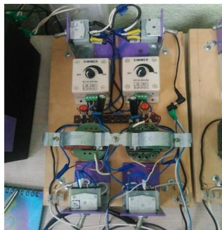
Рис. 3. Многоканальный источник постоянного тока: а – схема; б – внешний вид
