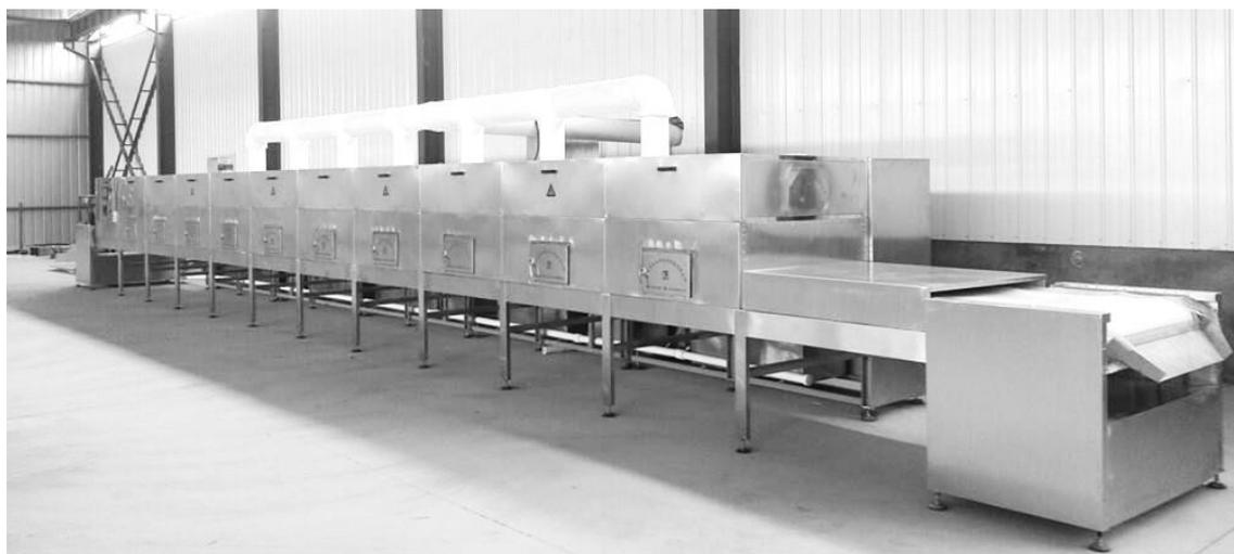
**Рис. 1.** СВЧ установка конвейерного типа для сушки пищевых продуктов
