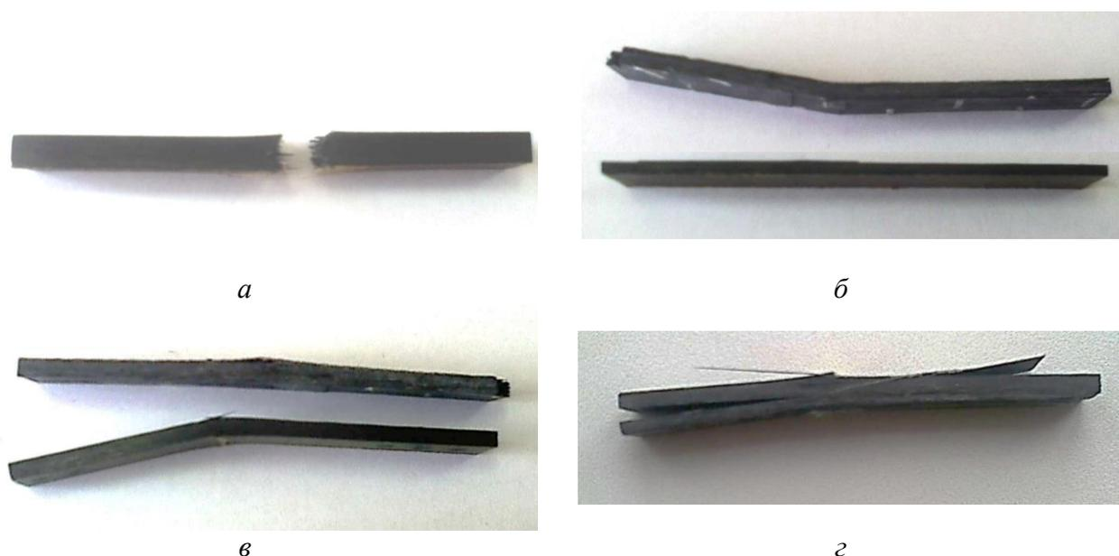
**Рис. 2.** Внешний вид образцов из квазиизотропного углепластика: контрольный:  $\sigma = 94,7$  МПа,  $E = 2823$  МПа (а); ППЭ  $20 \times 10^4$  мкВт/см<sup>2</sup>,  $\sigma = 174,8$  МПа,  $E = 3440$  МПа (б); ППЭ  $17 \times 10^4$  мкВт/см<sup>2</sup>,  $\sigma = 170,4$  МПа,  $E = 3190$  МПа (в); обработанный с ультразвуком: ППЭ  $17 \times 10^4$  мкВт/см<sup>2</sup>,  $f = 21300$  Гц,  $A = 2-4$  мкм,  $\sigma = 168,0$  МПа,  $E = 3605$  МПа (г)
