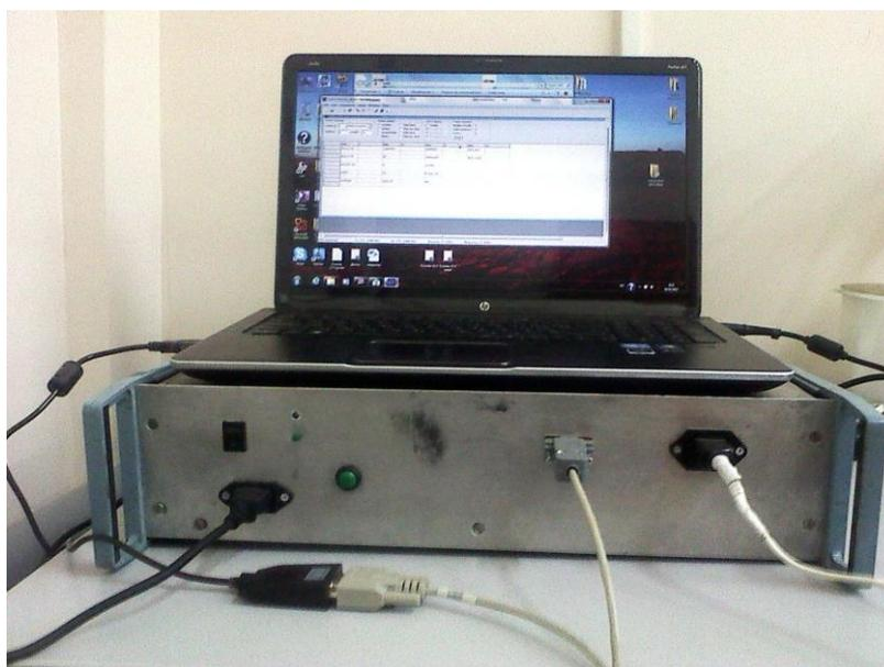
**Рис. 1.** Ультразвуковой генератор с программируемой частотой выходного напряжения
