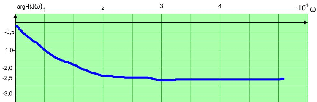
Рис. 6. Фазочастотная характеристика активного фильтра
