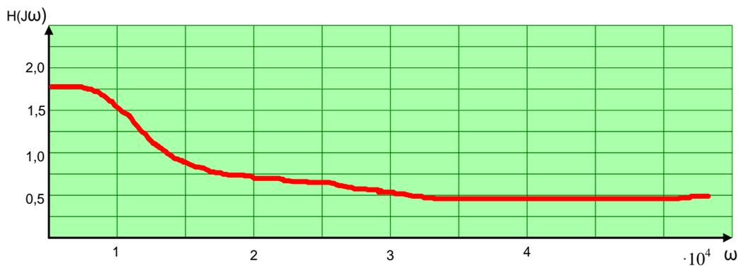
Рис. 5. Амплитудно-частотная характеристика активного фильтра
