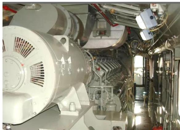
**Рис. 2.** Моторный отсек тепловоза ТЭП-70 с синхронным тяговым генератором типа ГСТ2800-1000У2
