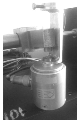
Рис. 2. Оснастка для проведения испытаний на разрыв нитей
