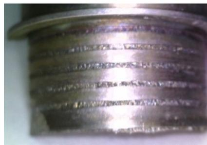
**Рис. 2.** Kern катода паяного молибден-кобальтовым припоем, приготовленным на основе бора аморфного
