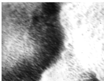
**Рис. 8.** Морфология нанокристаллической углеродной алмазоподобной пленки, синтезированной на поверхности Ti ионной имплантацией аргона с разрешением 15 нм ( $\times 250000$ )
