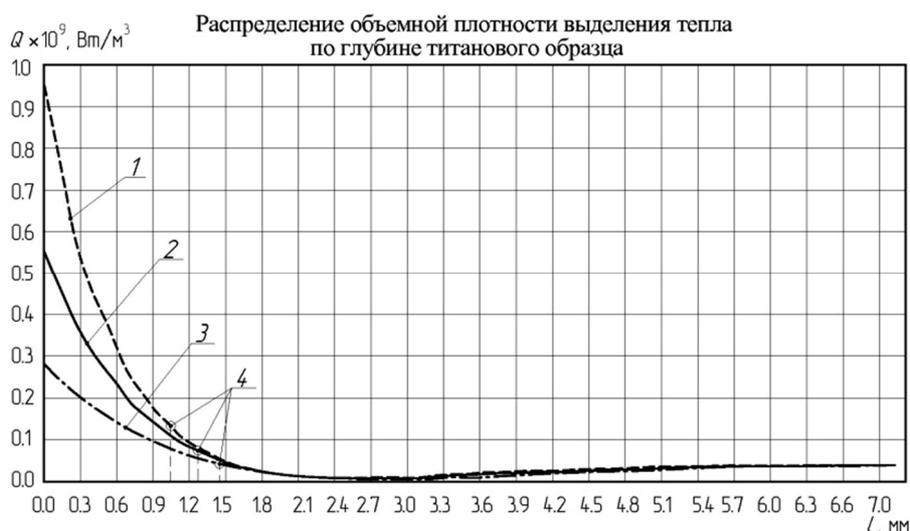
**Рис. 4.** Распределение объемной плотности тепловыделения  $Q$  в титановом образце по вертикальной оси  $Oy$  от периферии [0; 7] к центру [0; 0] и влияние частоты тока  $f$  на глубину скин-слоя (4): 1 – 150 кГц (---); 2 – 90 кГц (—); 3 – 50 кГц (----)
