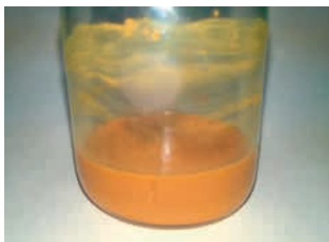
Рис. 6 Жидкий нанокомпозитный диэлектрик
