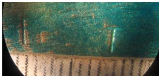
**Рис. 4.** Результат восстановления маркировочных обозначений на бронзе оловянной, полученный электролитическим травлением в смеси азотной и уксусной кислот
