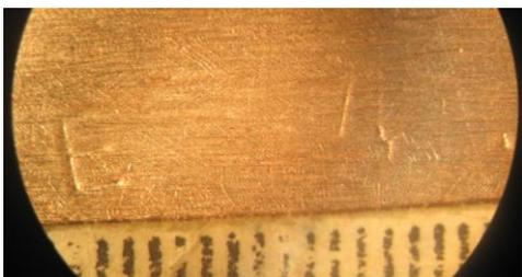
**Рис. 3.** Результат восстановления маркировочных обозначений на бронзе оловянной, полученный электролитическим травлением в 50%-м растворе азотной кислоты
