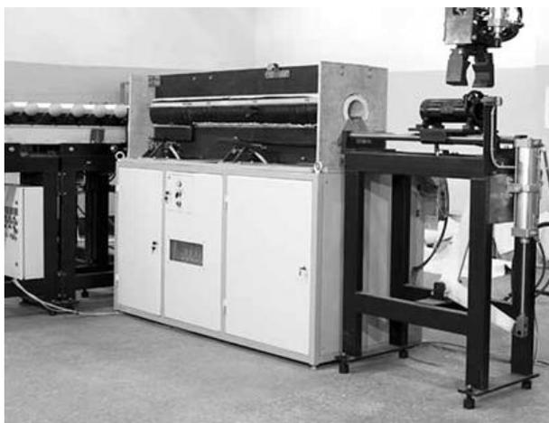
**Рис. 1.** Внешний вид двухсекционной установки индукционного нагрева сложных составных заготовок
